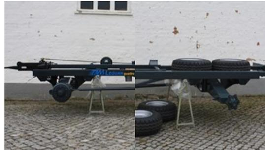
Lösen Sie die Transportverpackung und montieren Sie die Räder. Überprüfen Sie den Luftdruck der Bereifung.
