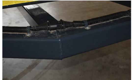
Lösen Sie die Schrauben des Lampenträgers und ziehen Sie ihn auf die benötigte Länge aus.
