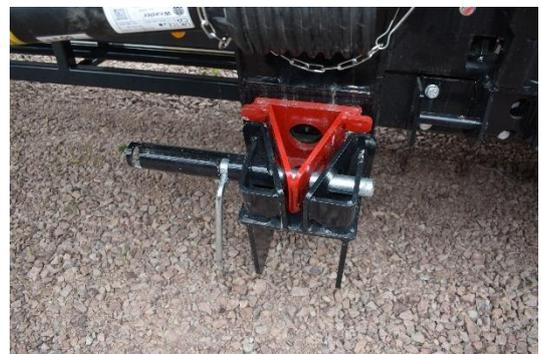
Arretieren Sie das Schneidwerk mittels der montierten Schiebolzen.
