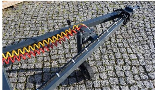
Klappen Sie das Stützrad in die Waagerechte bis der Arretierungsstift wieder einrastet
