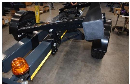
Legen Sie das Schneidwerk auf den Wagen und überprüfen Sie die Lage und den Ablagewinkel der Auflagen.
