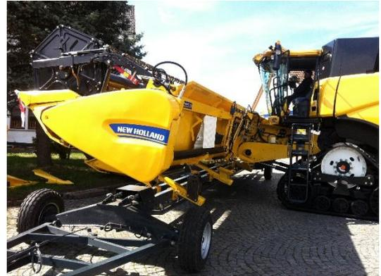
Durch Absenken des Schachtes kommt das Schneidwerk zuerst auf dem Querbalken zu liegen, und beim weiteren Absenken in den hinteren Ablagen.
