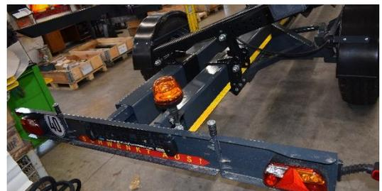
Messen Sie Ihr Schneidwerk aus, wo Sie die Aufnahmen montieren möchten. Montieren Sie die Aufnahmen wie abgebildet (siehe auch Beiblatt Montage der Auflagen).
