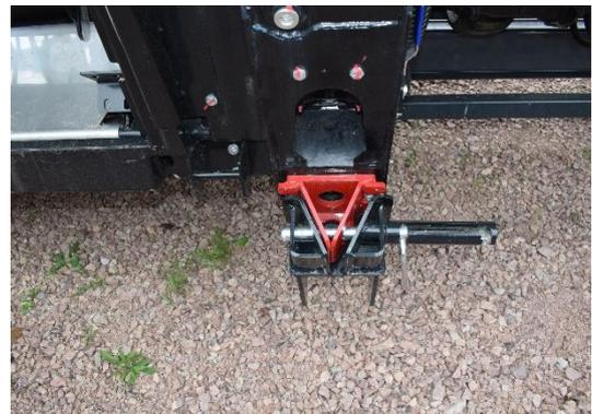
Bevor Sie den Schacht weiter absenken und aus dem Schneidwerk herausfahren, stellen Sie sicher, dass das Schneidwerk an den hinteren Kanten der Aufnahmen anliegt, gegebenenfalls mit dem Mähdrescher noch etwas zurückziehen.
